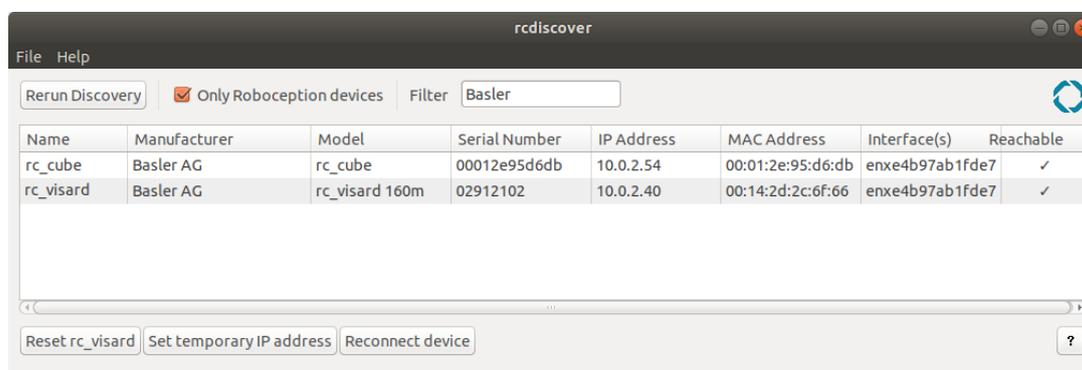
Abb. 3.1: *rcdiscover-gui*-Tool zum Aufspüren angeschlossener GigE Vision®-Geräte
