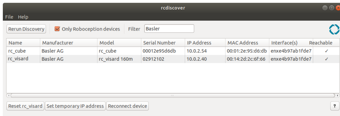
Abb. 4.2: rcdiscover-gui -Tool zum Aufspüren angeschlossener GigE Vision®-Geräte
